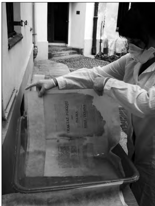
48. Prace przy konserwacji Traktatu Ryskiego (z Archiwum MSZ) w Centralnym Laboratorium Konserwacji Archiwaliów (2006 r.) / Works on conservation of the Treaty of Riga (from the Archives of Ministry of Foreign Affairs) in the Central Laboratory for Conservation of Archival Records (2006)
